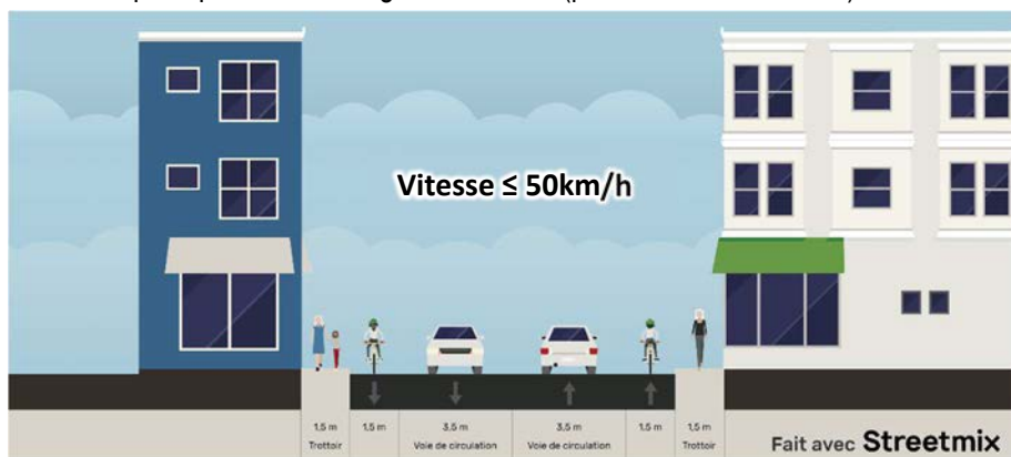
Figure 9 – Coupe type d'une bande cyclable
