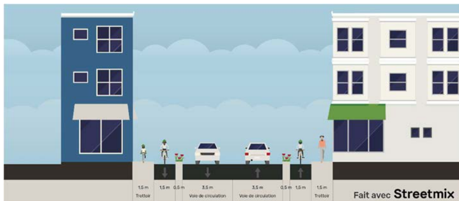
Figure 8 – Coupe type d'une double piste unidirectionnelle
