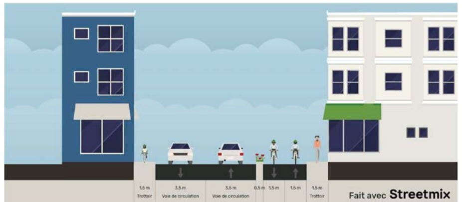
Figure 7 – Coupe type d'une piste bidirectionnelle
