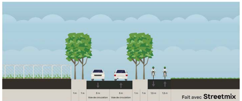
Figure 6 – Coupe type d'une voie verte
