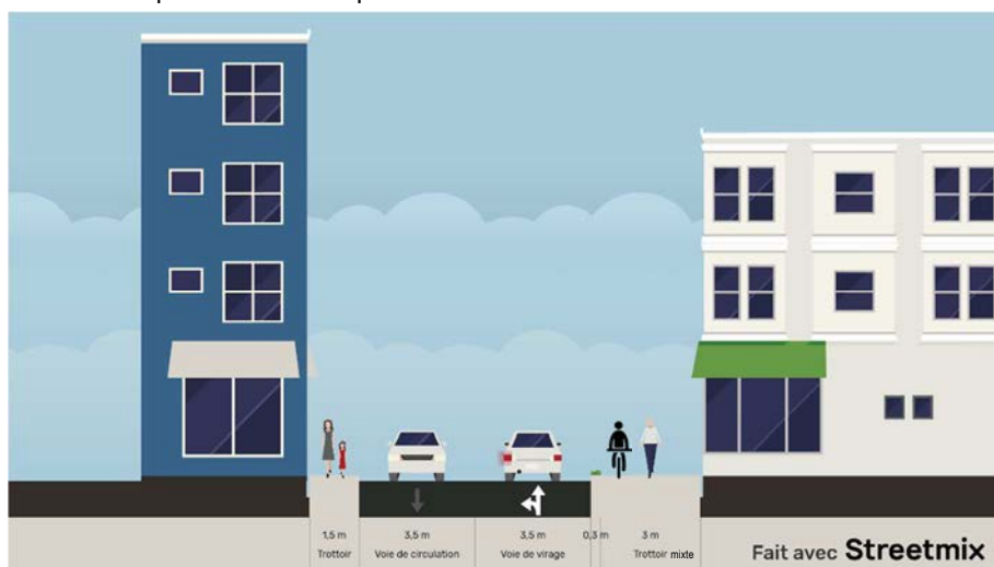
Figure 11 – Coupe type d'un trottoir mixte
