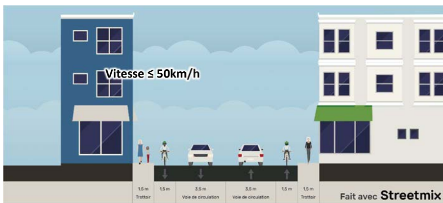
Figure 6– Coupe type d'une bande cyclable
