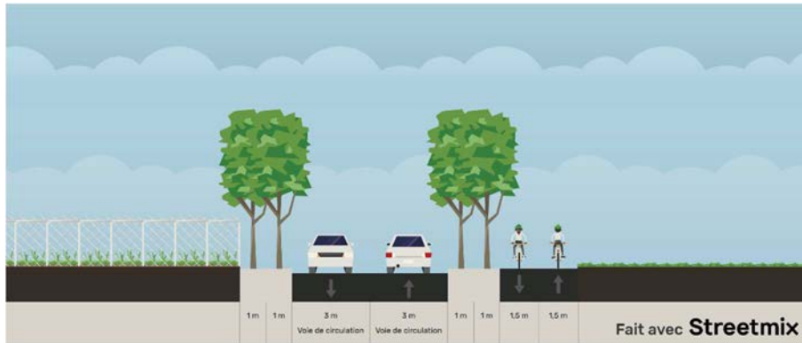
Figure 1 – Coupe type d'une voie verte
