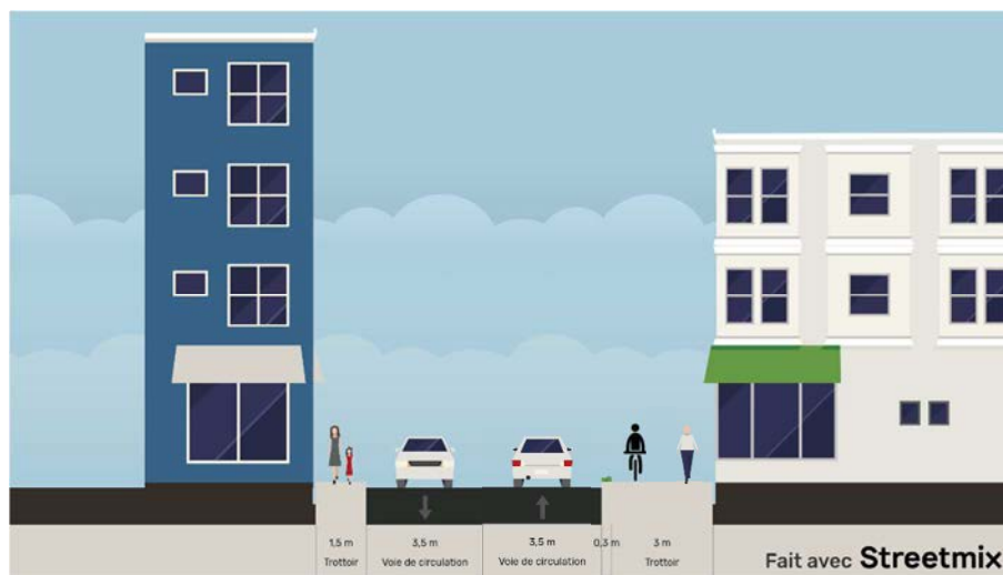
Figure 54 – Coupe type d'un trottoir mixte
