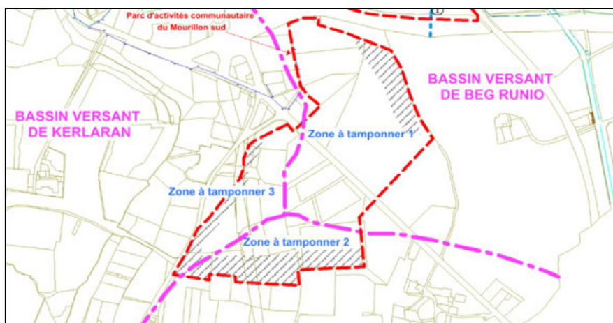
Figure 66 : Points bas de la zone d'étude où seront implantés des bassins de rétention des eaux pluviales
